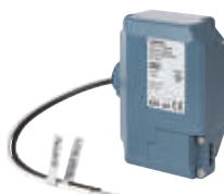
Fuente alimentación tipo JB de 80 mA 5WG1125-4CB23 Tipo: JB 125C23 Para montaje en el interior o anexas a cajas de conexionado tipo UL/NEMA mediante conector roscado de 1/2". Tensión de alimentación de 120 V CA 50..60 Hz.
