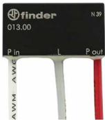
El módulo 013.00 le permite instalar cualquier dispositivo que necesite señal de fase del pulsador sin alterar el cableado eléctrico existente con pulsador en neutro.
