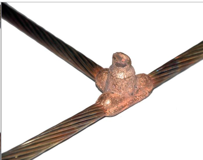
Una soldadura CONFORME debe cubrir la totalidad de los conductores con metal fundido y no con escoria.
