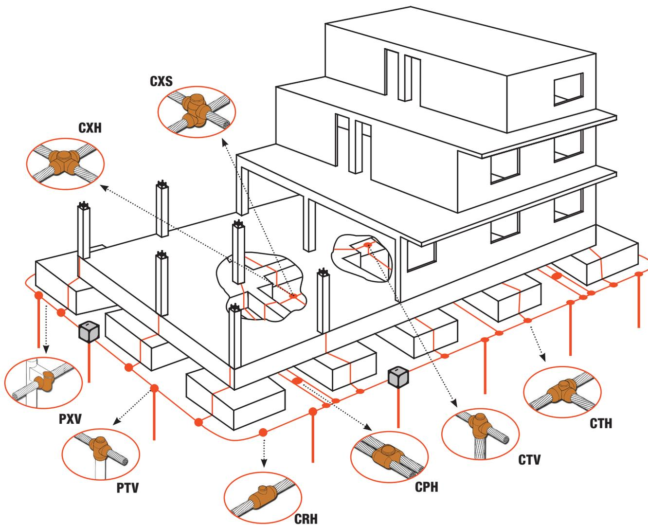
Disponemos de los moldes de soldadura aluminotérmica para conexionado pica-cable y cable-cable en instalaciones de media y baja tensión.
