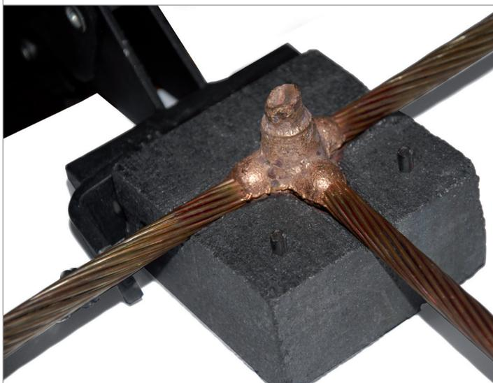
Abrir el molde a través de las tenazas, Nunca tocar el molde sin protección tras una soldadura.
