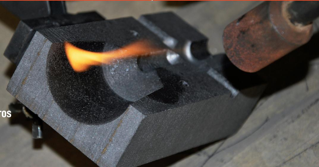
Calentar molde con soplete para eliminar humedad y EVITAR SOLDADURAS INCORRECTAS.
