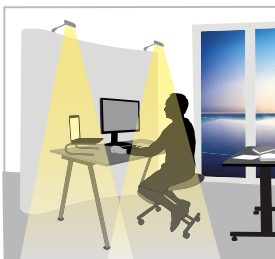
Con poca luz y con la detección del movimiento, el 18.51 enciende automáticamente las lámparas.
